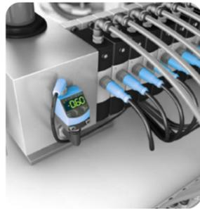
**21 Контроль давления воздуха в пневматических захватах**
